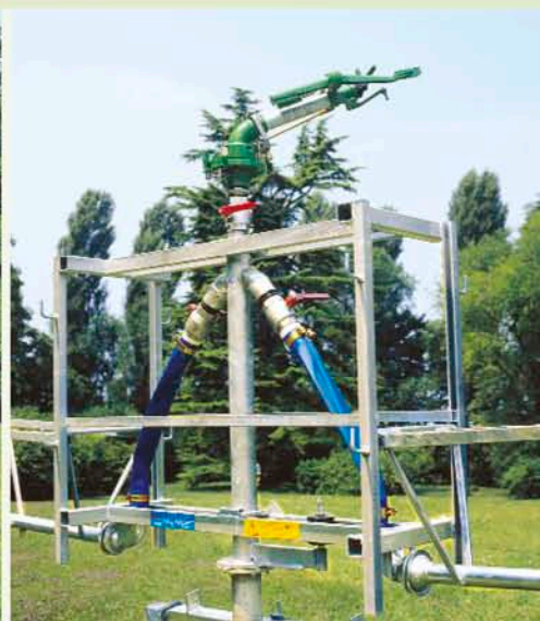
ala con irrigatore - rampe avec irrigateur - ala con aspersion - boom with rain gun.
