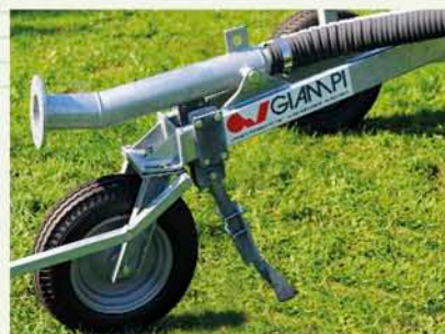
traccia solchi per carrello - trace - sillons pour chariot - traza-surcos para carretilla-furrow tracer for trolley.
