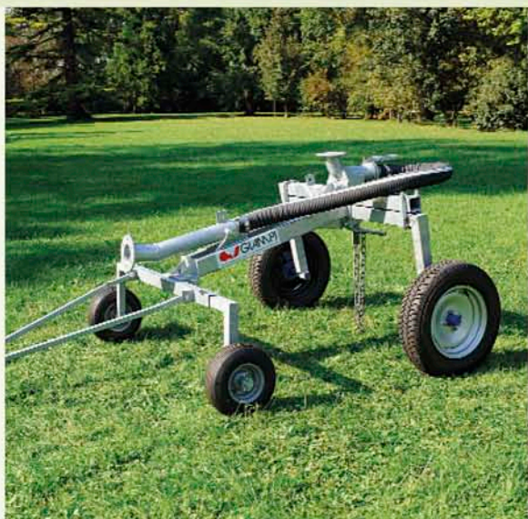
carrello porta ala con doppia ruotina anteriore - chariot porte-rampe avec double roue anterieure - carrellilla porta ala con doble rueda anterior - trolley with double front wheel.
